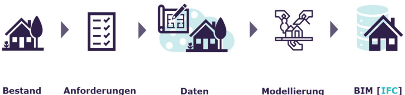
Abbildung 17: Genereller Arbeitsablauf der Bestandsmodellierung 113
