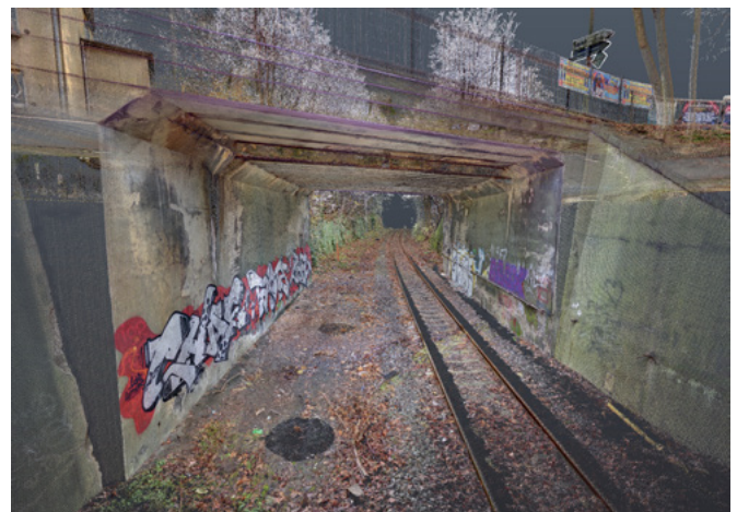
Abbildung 21: Punktwolke des Gesamtareals „Brücke und Straße“ des TLS Trimble-X7 mit in orange-weiß gekennzeichneten Scannerstandorten (links) und Punktwolke des TLS Zoller + Fröhlich Imager 5016 der Nahansicht der Brücke 119
